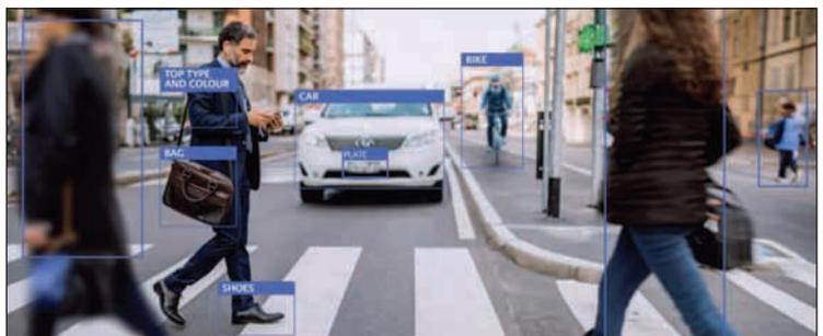
Le telecamere AI di i-PRO eseguono anche 3 applicazioni assieme sulla stessa telecamera: analizzano le immagini in modo indipendente e avvisano il sistema di gestione solo per anomalie
