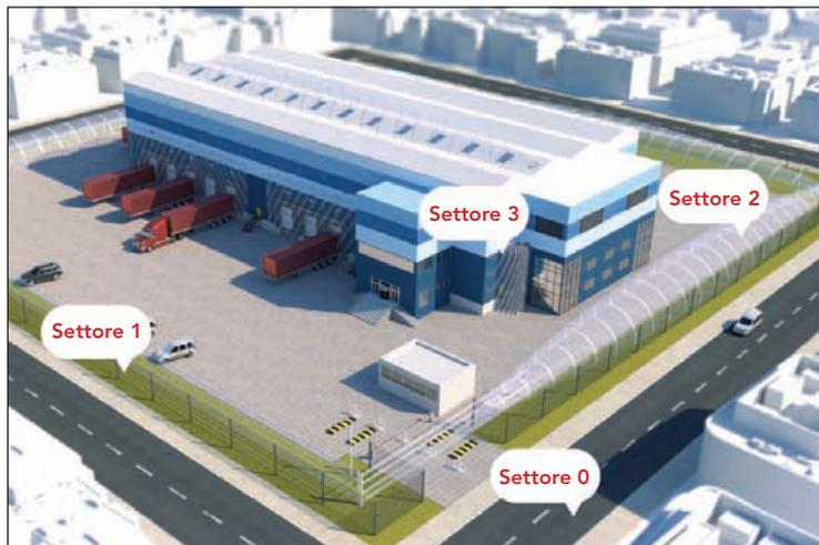
Settore 0: perimetro esterno alla proprietà - Settore 1: delimitazione fisica della proprietà - Settore 2: perimetro esterno dell'edificio - Settore 3: perimetro interno dell'edificio
