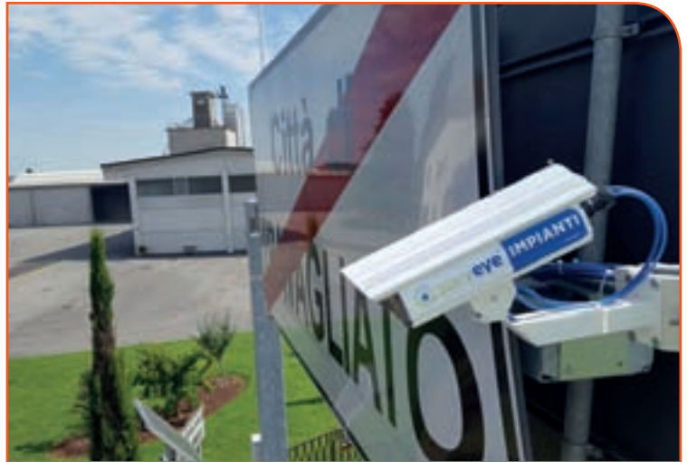
■ La soluzione: 18 telecamere Vigilante A1C, telecamere ANPR con OCR e contesto integrato ad 1.3mpx, il tutto integrato sulla piattaforma software Xscanner
